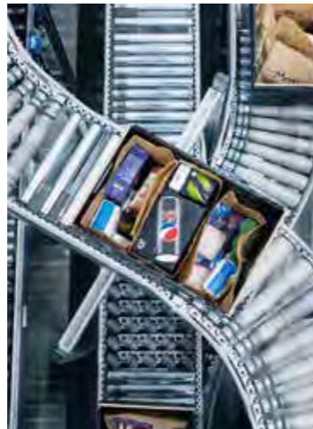
Lådor fyllda med matvaror på väg mot den automatiska sorteringsbufferten, där de sedan skickas vidare till bilarna. Med teknik sorteras lådorna så att de hamnar i rätt ordning inför rutten.
