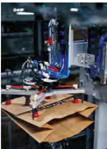
Den nyutvecklade "påsresroboten" suger upp kassar, vecklar ut dem och ställer dem i lådor innan de åker iväg för att packas.
